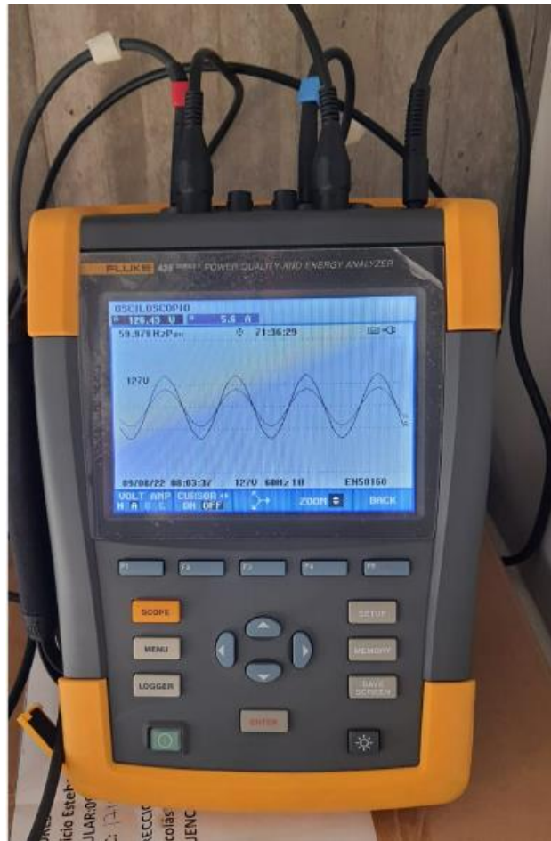
Figura 5. Analizador de calidad de energía Fluke 435 series II.
